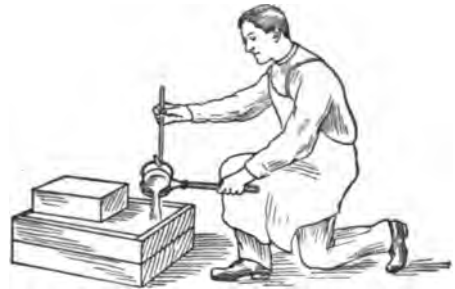
Fig. 4—Pouring the Metal
